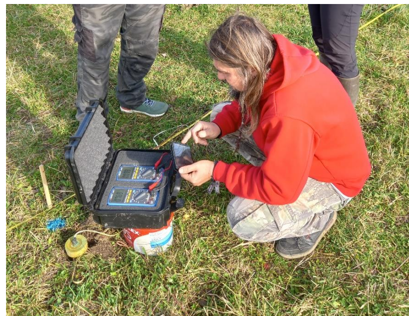
Obr. 2 Měření bludných proudů s měřícím kompletem BLOW-2. V popředí nepolarizovatelná elektroda.
