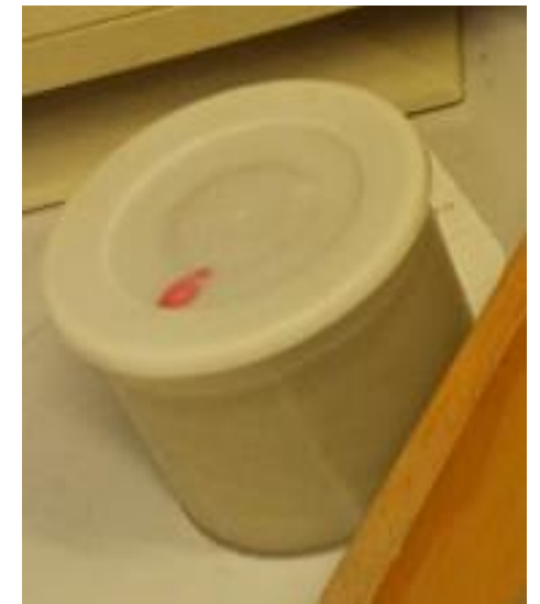
Obr. 9 Hermetické uzavretie vzorky pôdy (foto: autor)
