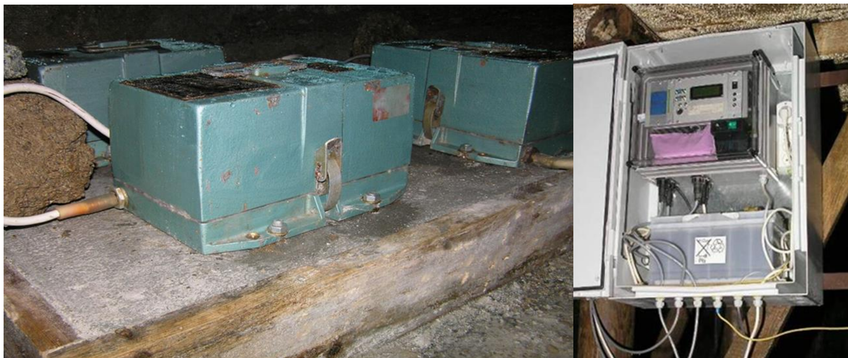
Obr. 2 Seismometry SM3 a registrační aparatura PCM3-EPC se záložní baterií ve vodotěsné skříni (foto: Lednická)
