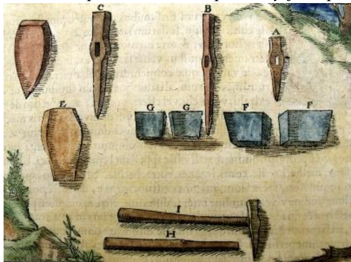
Obr. 4 Nástroje rozrušovací – neboli želízka a klíny, kterými se hornina rozrušuje. Želízko A, zasekáček B, želízko žumpové C, skalní klín D, klín E, hrubý klín F, plechový klín G, dřevěná rukojeť H, v želízku zasazená rukojeť I (Agricola, 2001)
