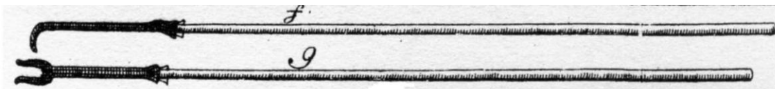
Obr. 22 Hřablo a vidle – f, g, používané dle Delia při metodě sázení ohně. Oba nástroje sloužily jak k obtrhávání stropů se stěn komor, tak i k pořádání ohně z určité, již bezpečné, vzdálenosti. Doporučuji vrátit se k obrázku z práce Rösslerovy, tedy časově zhruba 100 let nazpátek, kde v ruce pracovníka vidíme právě takové vidle. Je zřejmé, že bylo známo již dlouho a rozšířeno bylo po většině tehdy funkčních revírů (Delius, 2012)
