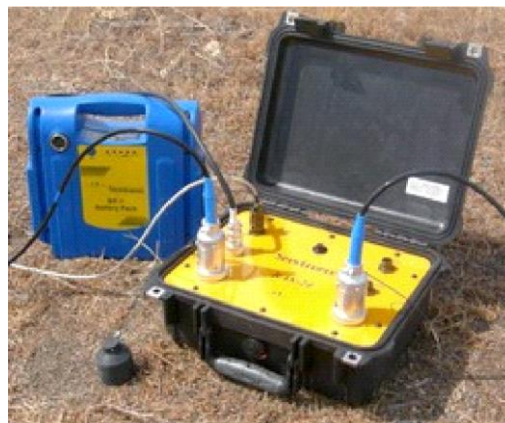
Obr. 1 Zařízení pro ST, zleva přístroj RAS-24, kabel s piezosnímači a samotný snímač
