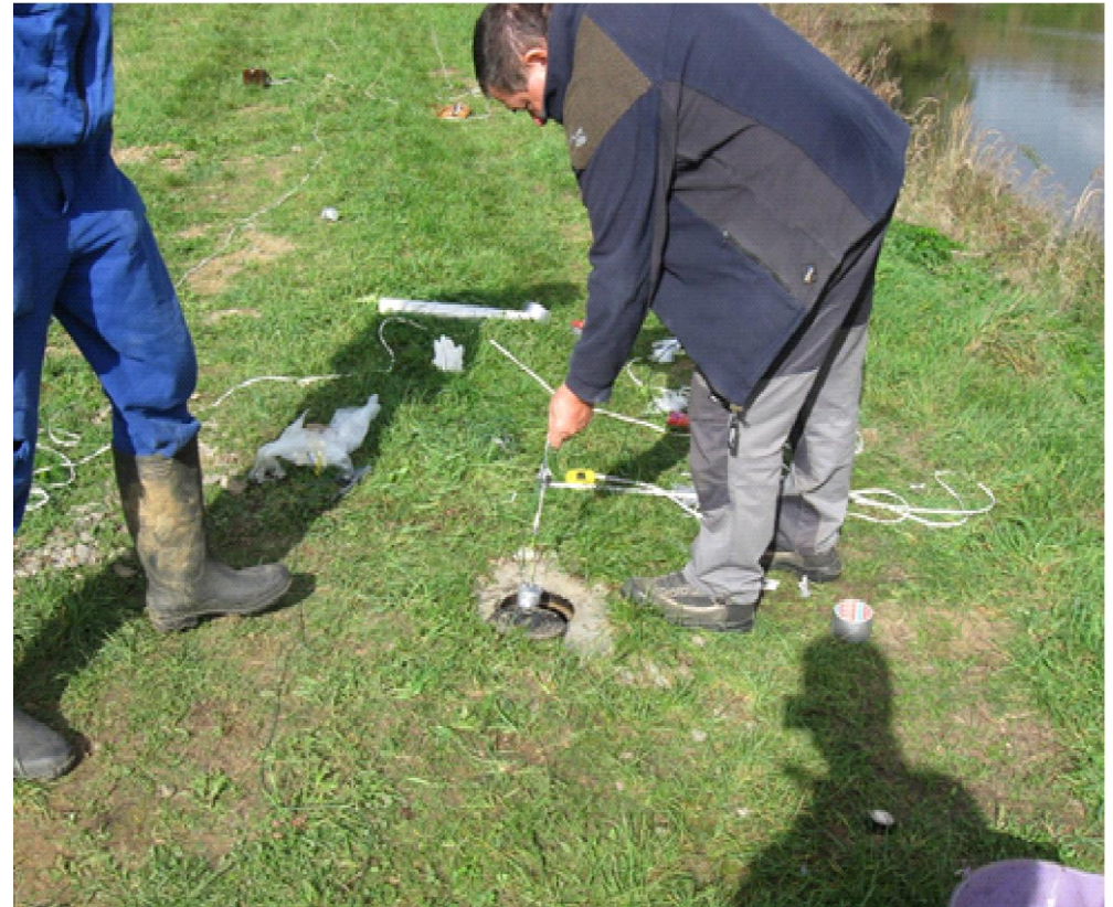
Obr. 3 Zapouštění pyrotechnické náložky do vrtu
