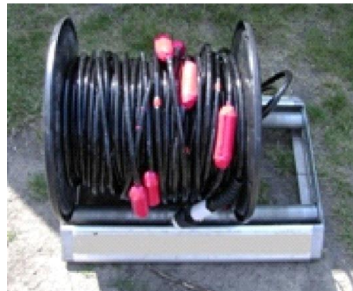
Obr. 1 Zařízení pro ST, zleva přístroj RAS-24, kabel s piezosnímači a samotný snímač
