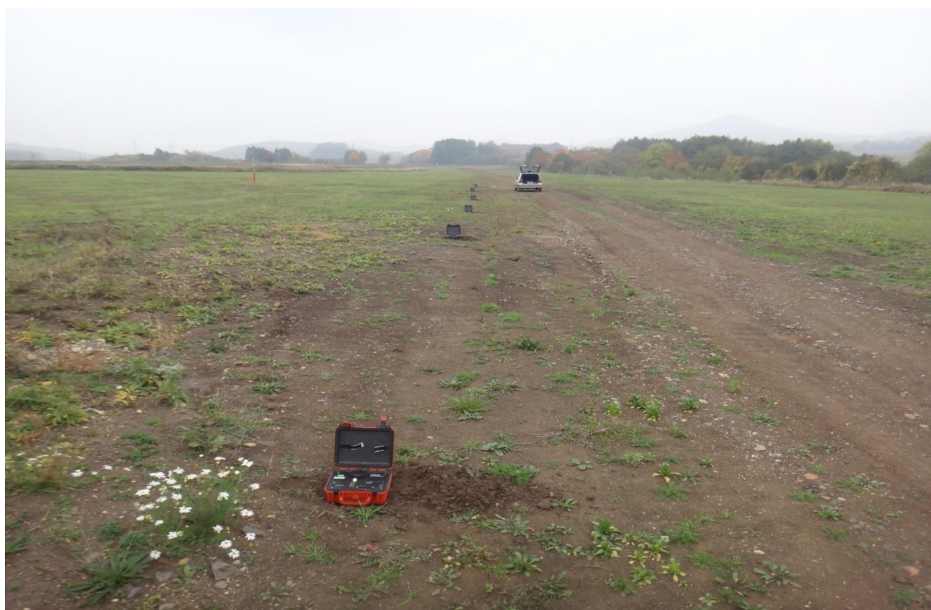
Obr. 11 Realizace seismického profilu podloží aparaturami BRS32 na trase dálnice D8.
