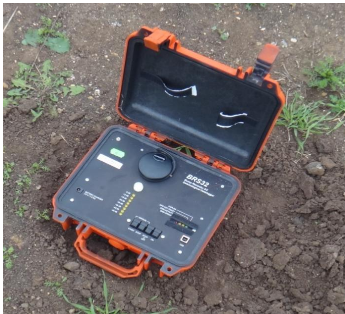
Obr. 10 Instalace seismického záznamníku BRS 32 při seismickém profilování
