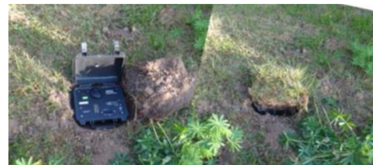
Obr. 13 Realizace uložení záznamníku BRS 32 při terénním měření v lokalitě kamenolomu Krásno
