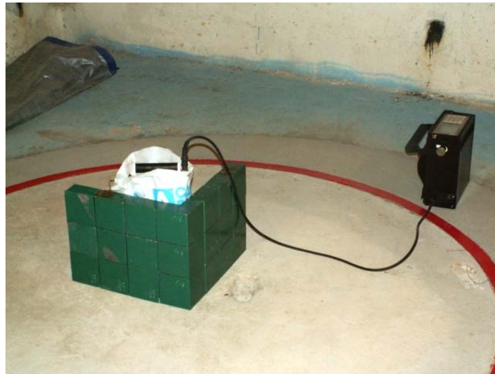
Obr. 2 Odstínění gama záření z různých směrů pomocí olověných cihel při sledování účinků stěn
