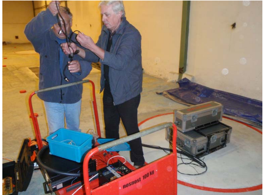
Obr. 6 Příprava leteckého gamaspektrometru pro záměr na standardu PU
