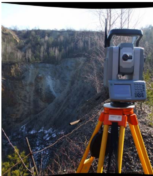
Obr. 3 Terénny zber dát pomocou prístrojov GNSS Leica GPS 900 CS a Trimble VX Spatial Station (Filúsová, 2011)
