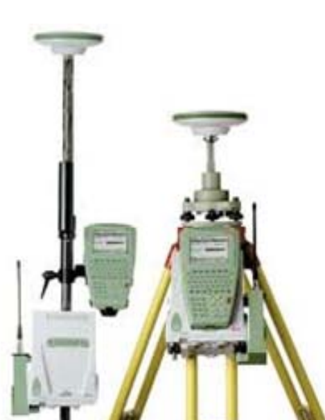
Obr. 3 Terénny zber dát pomocou prístrojov GNSS Leica GPS 900 CS a Trimble VX Spatial Station (Filúsová, 2011)
