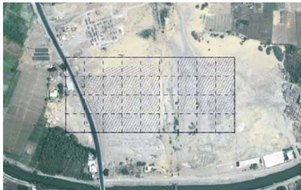
Obr. 4: Schéma meracej siete DEMP (vybodkované štvorce a ich časti).
