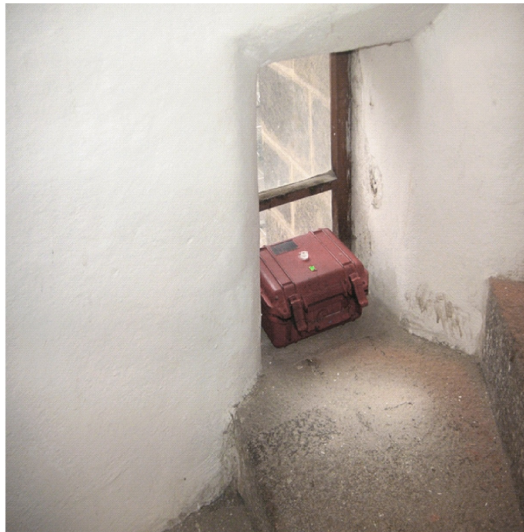
Obr. 4 Umístění aparatury BRS32 ve výklenku zdiva – 84 m.
