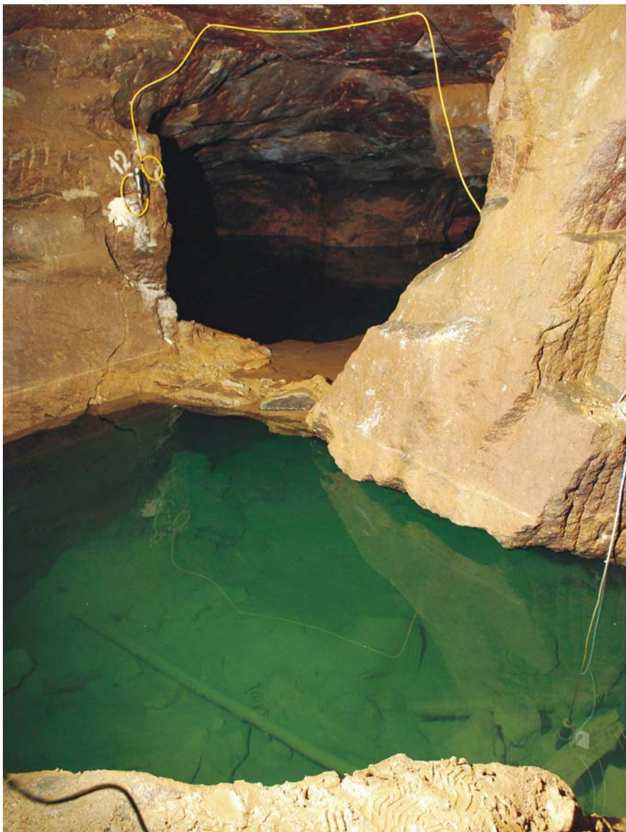
Obr. 4 Stanoviště V2/KV2, vlevo na stěně měření pohybu bloků podél pukliny na pilíři, vpravo ve vodě sonda měřící úroveň hladiny důlních vod, foto: Lednická
