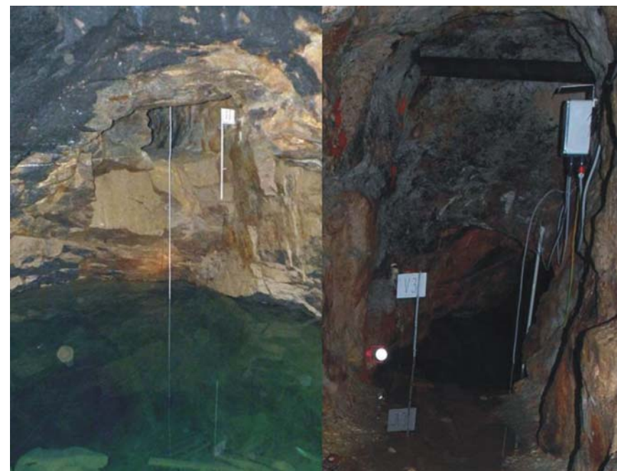
Obr. 7 Stanoviště V3/KV3 v období přetoku důlní vody do chodby vedoucí do komory K2 (vpravo, foceno z chodby) a v období poklesu hladiny v roce 2008 (vlevo, foceno z komory K3), foto: Lednická
